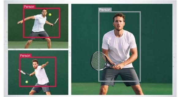
**Funktionsweise Objekt-Tracker: Rechts initiale Bounding Box, links automatische Anpassung der Bounding Box – Quelle: EDAG Group**
