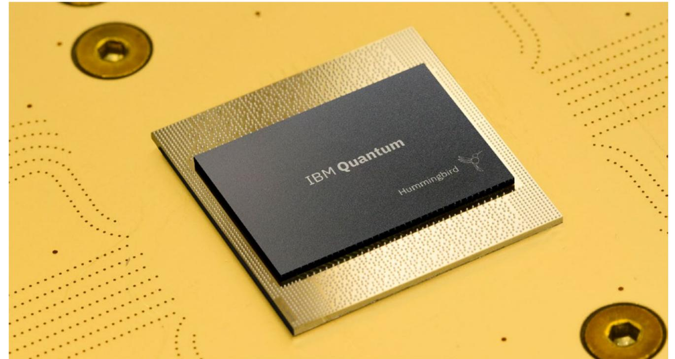
IBM Quantum Hummingbird ist ein 65-Qubit-Prozessor, der in der IBM Cloud für Mitglieder des IBM Q Network verfügbar ist. Quantenprozessoren stützen sich auf die Mathematik der Elementarteilchen, um die Rechenkapazitäten zu erweitern und Quantenschaltungen anstelle der Logikschaltungen digitaler Computer auszuführen. (Credits: Connie Zhou für IBM)
