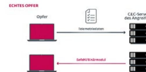
Abb. 3: Der infizierte Rechner eines Opfers übermittelt Telemetriedaten an den C&C-Server des Angreifers und erhält Befehle oder Binärmodule.
