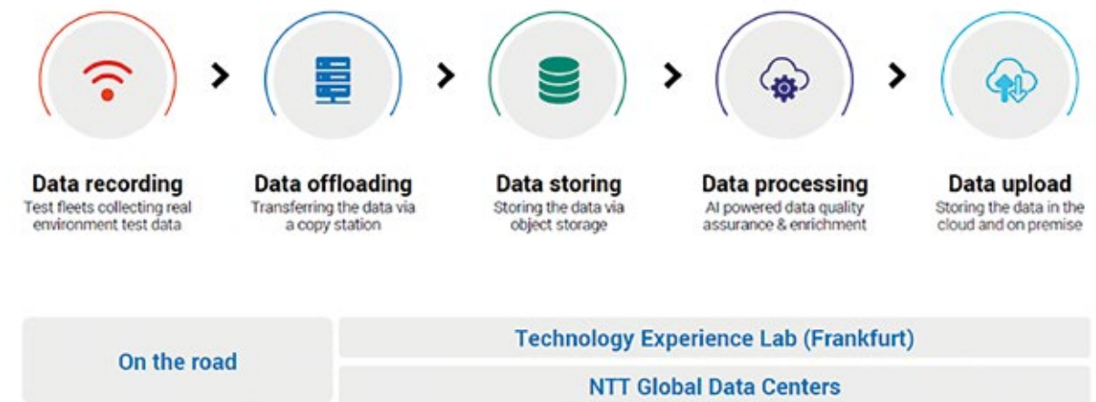
Abbildung 1: Der Weg der Daten von der Straße ins Rechenzentrum und in die Cloud.
